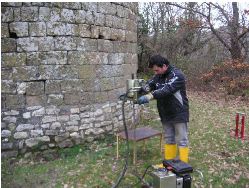
Foto n. 5 – Prova penetrometrica dinamica leggera P5
