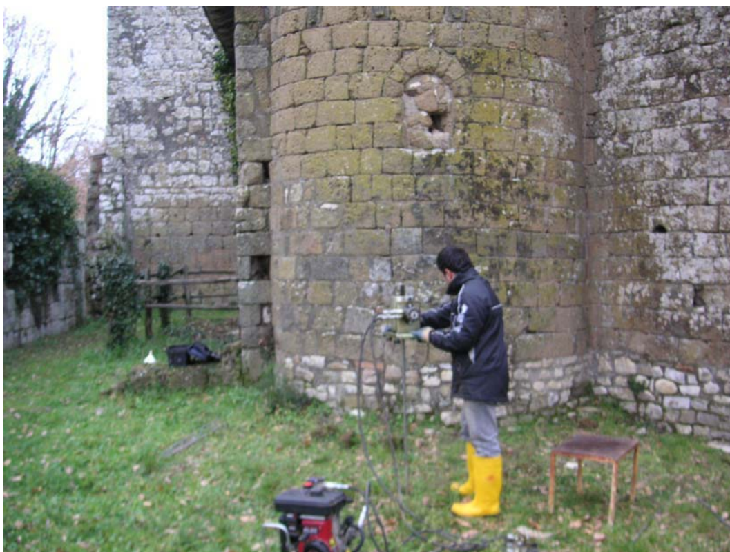
Foto n. 4 – Prova penetrometrica dinamica leggera P4
