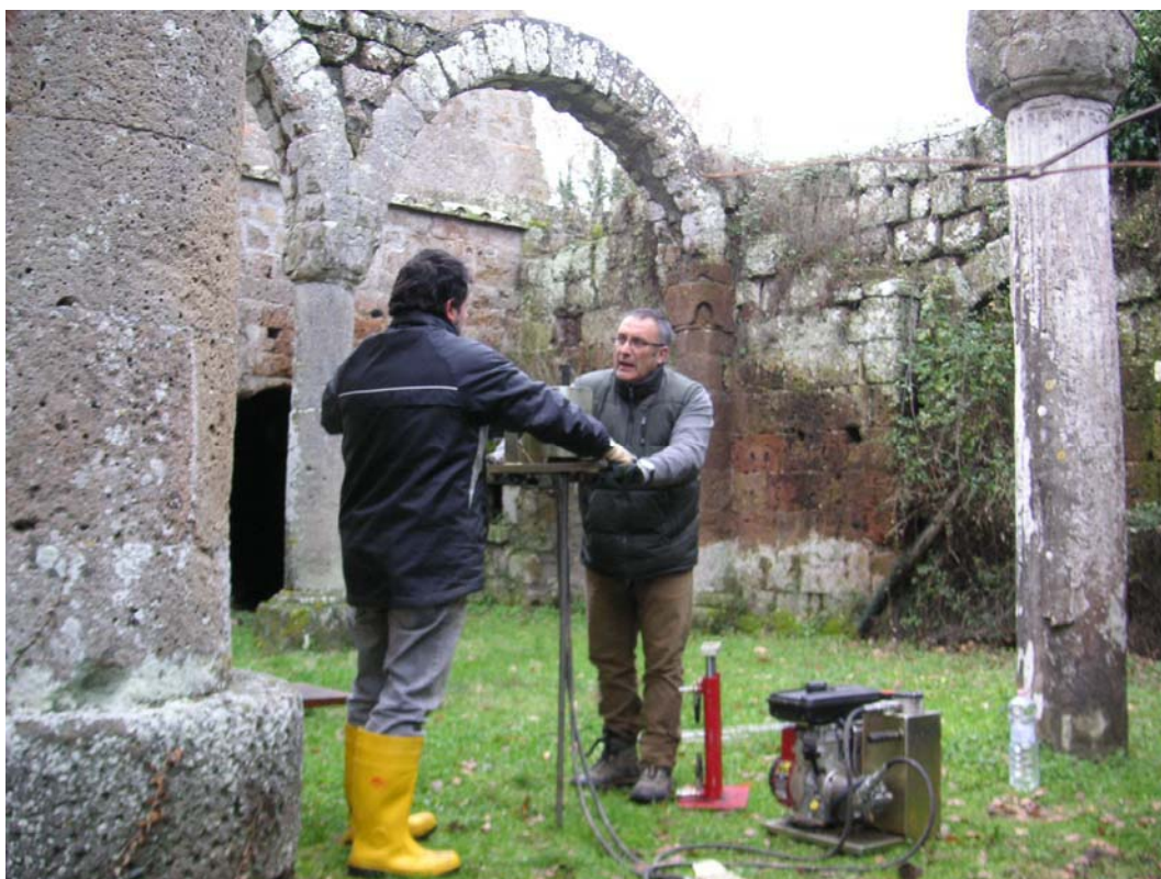
Foto n. 1 – Prova penetrometrica dinamica leggera P1
