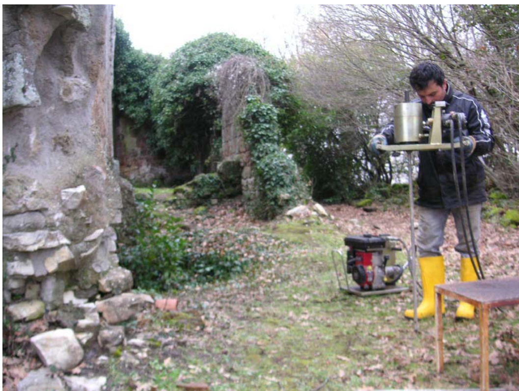
Foto n. 6 – Prova penetrometrica dinamica leggera P6
