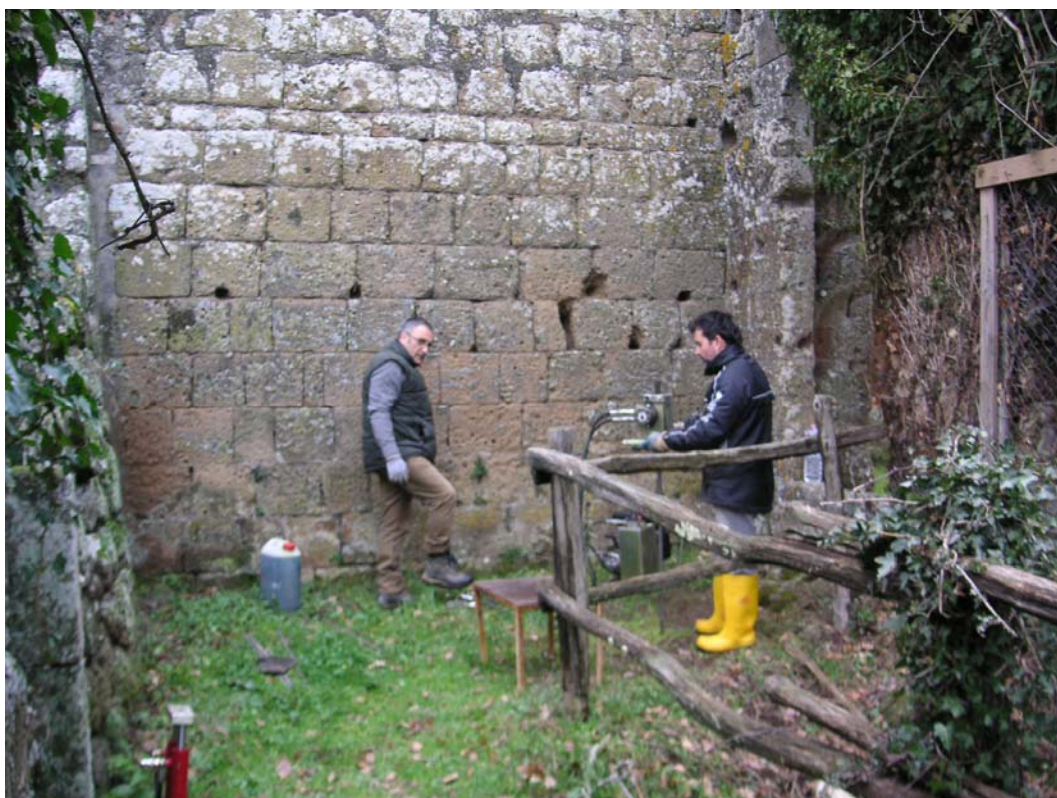
Foto n. 2 – Prova penetrometrica dinamica leggera P2
