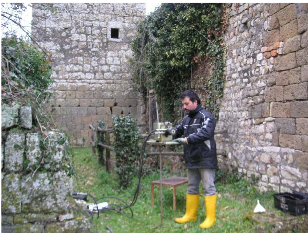
Foto n. 3 – Prova penetrometrica dinamica leggera P3
